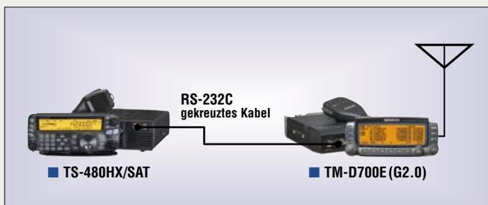
Die DX-Packet-Cluster-Tuning-Funktion steht zur Verfügung, wenn der TS-480HX/SAT mit einem TM-D700E (G2.0) verbunden wird. DX-Cluster-Meldungen, die mit dem TM-D700E (G2.0) empfangen und angezeigt werden, können genutzt werden, um den TS-480HX/SAT augenblicklich auf die Frequenz der gemeldeten DX-Station abzustimmen. Dies ist ein leistungsfähiges Werkzeug, um seltene Stationen aufzuspüren.
