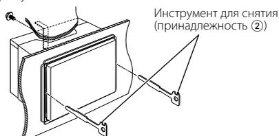
4. Опустите инструменты для снятия вниз и, нажимая внутрь, выдвиньте устройство наполовину.
