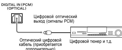
Оптический цифровой кабель (приобретается дополнительно)
