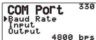
Establezca la velocidad de comunicación del GPS externo u otro equipo que esté conectado al terminal GPS. Cuando conecte un receptor GPS, la velocidad se establecerá a 4800 bps (NMEA)/ 9600 bps (Formato IPS: SONY).
