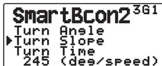
Valor adicional para cambio de dirección de desplazamiento (1 ~ 255 (10grados/velocidad)).
