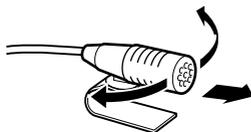
Ajuste a direcção do microfone ao condutor.
