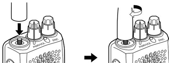
**Nota:** La antena no es una empuñadura, ni un llavero ni un punto de acoplamiento del micrófono/ altavoz. Si utiliza la antena para estos fines, podría dañarla y mermar el rendimiento del transceptor.
