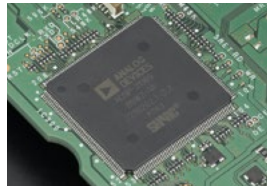
DSP für Sub-Empfänger ADSP-21369, mit 260 MHz getaktet
