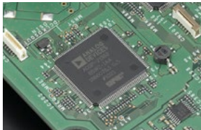
DSP für die Haupt-RX-ZF und den Sender ADSP-21363, mit 333 MHz getaktet
