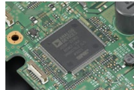
Bandscope-DSP ADSP-21363, mit 333 MHz getaktet
