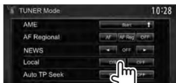
**ON** Seleccionelo para sintonizar solamente emisoras con una señal suficientemente fuerte. El indicador LOS se enciende.
