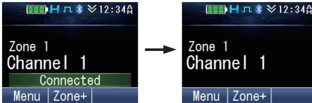
El transceptor transita a cada modo al comenzar la comunicación FPU. Para usar el Protocolo de Interfaz con PC, ejecute los comandos PC.
