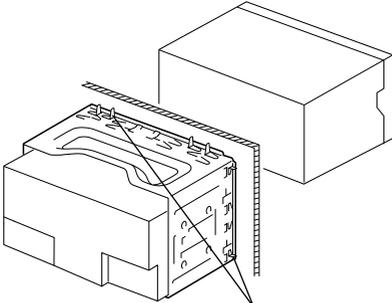
Doble las lengüetas del manguito de montaje con un destornillador o similar y fíjelo.
