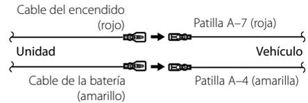
[2] La patilla A-7 (roja) del conector ISO del vehículo está conectada a la fuente de alimentación constante, y la patilla A-4 (amarilla) está interconectada con el encendido.
