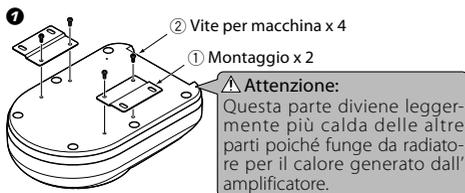
Attaccate i montaggio ① sull'unità altoparlante in modo ben saldo usando le viti per macchina ②. Badare a che i cavi collegati non si frappongano fra il diffusore e i montaggio ①.
