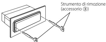
3. Abbassare l'attrezzo di rimozione verso la parte inferiore e tirare parzialmente in fuori l'unità premendo verso l'interno.
