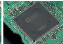
DSP für Sub-Empfänger ADSP-21369, mit 260 MHz getaktet
