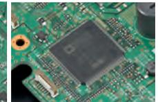
Bandscope-DSP ADSP-21363, mit 333 MHz getaktet
