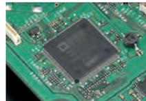
DSP für die Haupt-RX-ZF und den Sender ADSP-21363, mit 333 MHz getaktet
