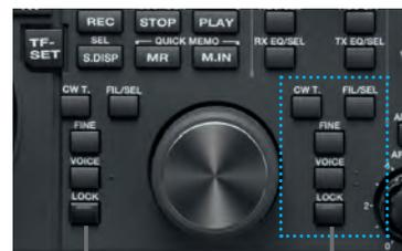
Die Tasten für die am häufigsten genutzten Funktionen befinden sich rund um die beiden Knöpfe. Das unterstützt eine schnelle Bedienung.
