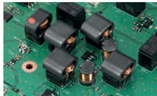
Induktiv gegengekoppelte HF-Verstärker
