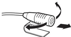
Regolare la direzione del microfono rispetto al guidatore.
