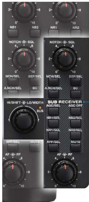
Sub-receptor con controles para eliminación extensiva de interferencias situado a la derecha del panel frontal.
