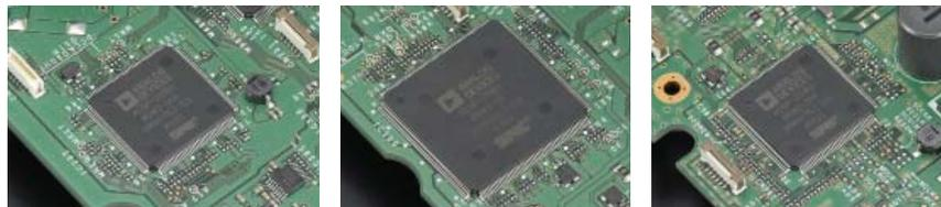
Unidad de transmisión ADSP-21363 con reloj @333 MHz para el DSP FI principal
